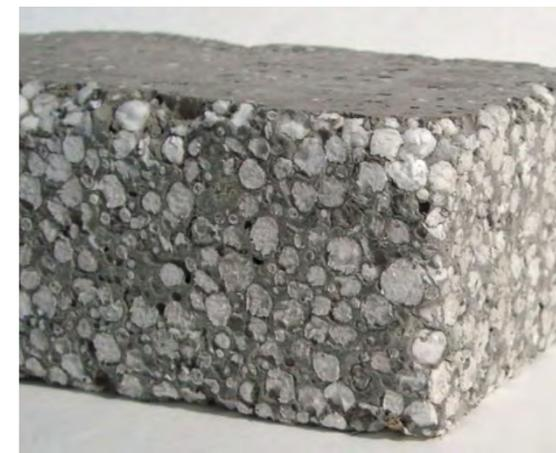
Рис. 123. Теплоизоляционный бетон
